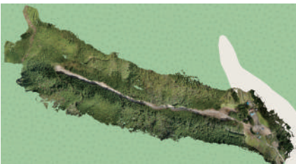
連続写真から生成した正射変換画像(オルソ画像)
